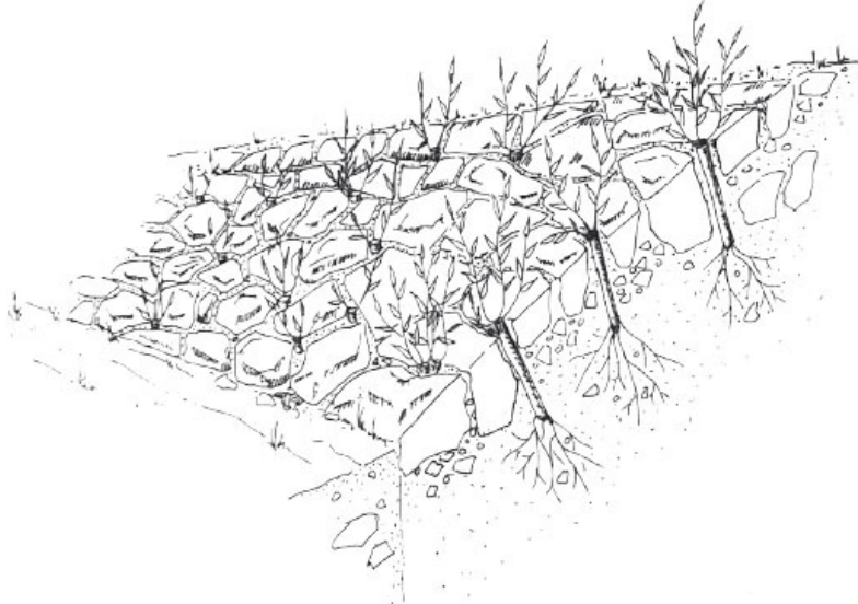
Imatge 13. Esquema escullera vegetada o viva
